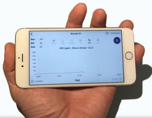
il datalogger multi-sensore capace di restituire in tempo reale 5 parametri di qualità dell'aria interna consultabile da piattaforma web e/o applicazione smartphone
